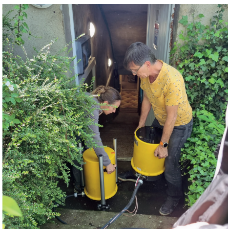
Installation du gravimètre absolu dans la cave sismique par Germinal Gabalda et Lucia Seoane (GET/OMP) Crédit - Lydie Gailler (OPGC)
